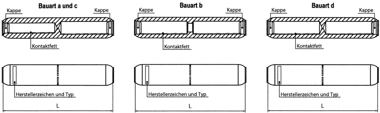
Verbindung nach Verarbeitung mit Schrumpfschlauch (Länge min. 160mm) schützen.
