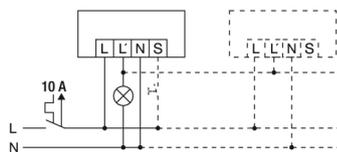
Standardbetrieb mit der zusätzlichen Ansteuerung durch Schliesstaster.
