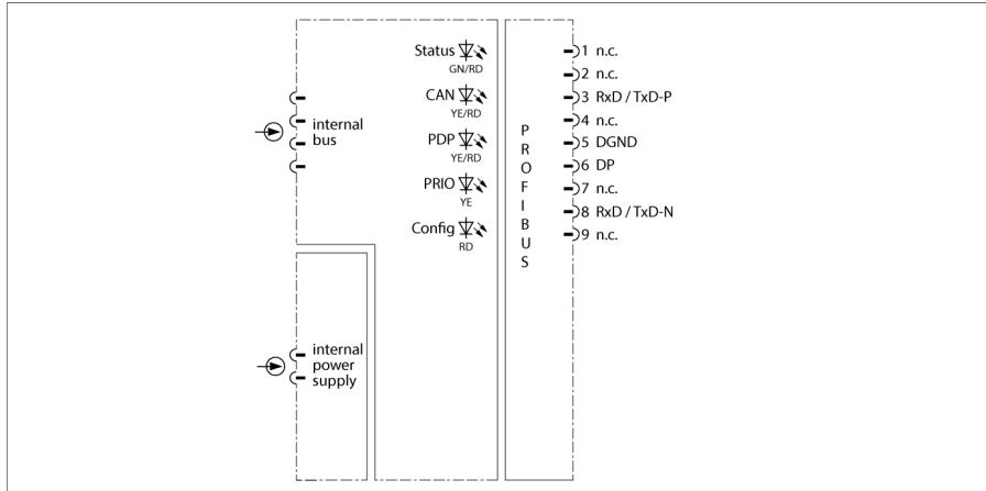
Das Gateway GDP-N dient zur Anbindung des excom®-Systems an PROFIBUS-DP-Netzwerke. Zum Anschluss an den PROFIBUS können entweder Lichtwellenleiter oder Kupferleitungen verwendet werden. Bei Verwendung von Lichtwellenleitern muss für den Datenaustausch zwischen drahtgebundenem und optischem PROFIBUS ein LWL-Kopplerpaar eingesetzt werden.
