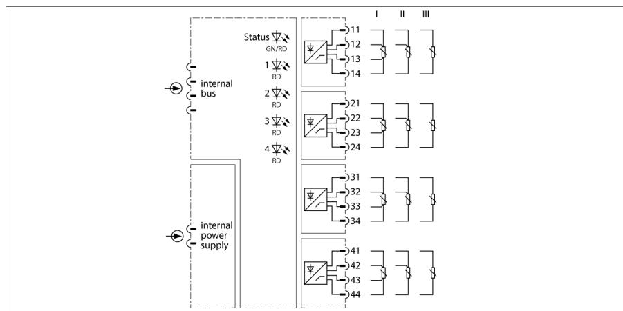
Das Eingangsmodul TI41Ex dient zum Anschluss von 2-, 3- und 4-Leiter-Temperaturführlern der Typen Pt100, Ni100 und Cu100.
