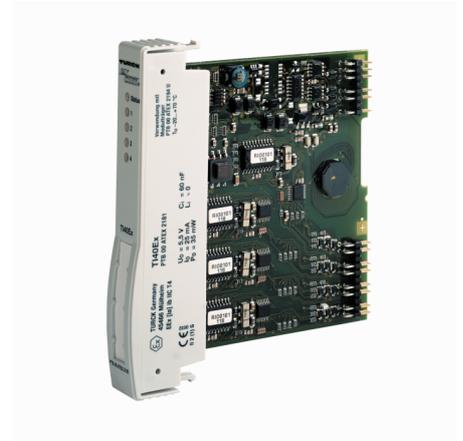
Das Eingangsmodul TI40Ex dient zum Anschluss von 2-, 3- und 4-Leiter-Temperaturfühlern der Typen Pt100, Pt200, Pt500, Pt1000, Ni100 und Cu100 sowie zum Anschluss von Thermoelementen der Typen B, E, D, J, K, L, N, R, S, T und U. Das Modul kann auch zur Messung von Kleinstspannungen (-75...+75 mV, -1,2...+1,2 V) und für Widerstandsmessungen genutzt werden (0...30 Ω, 0...300 Ω, 0...3 kΩ).
