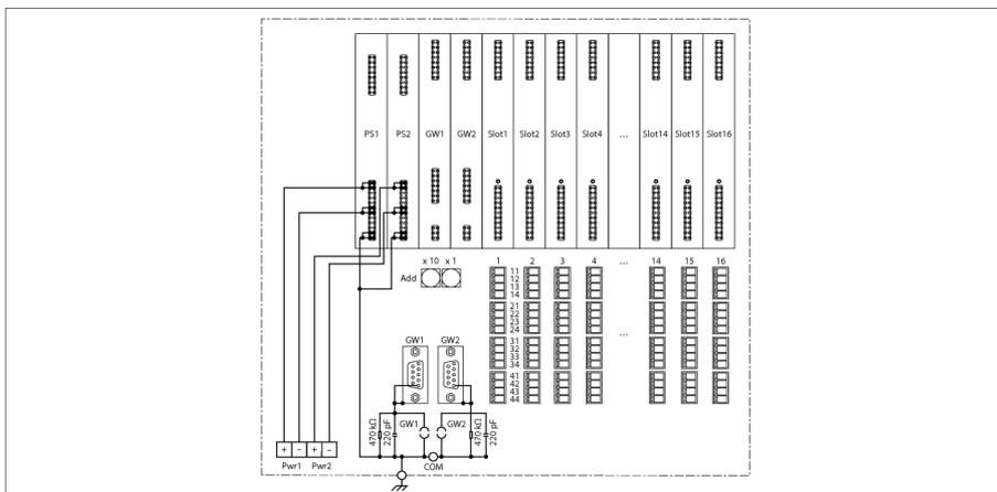
Der Modulträger MT16-N besteht aus einer Backplane und dem eigentlichen Trägersystem. Er dient zur Aufnahme von zwei Gateways, zwei Netzteilen sowie 16 E/A-Modulen. Es können so bis zu 128 binäre Ein-/Ausgänge oder 64 analoge Ein-/Ausgänge bzw. jede Mischform an den Modulträger angeschlossen werden.
