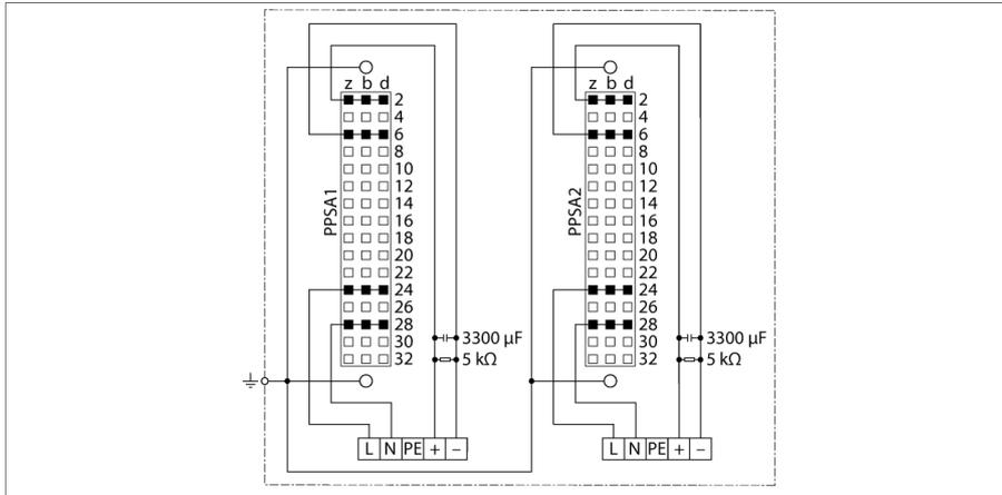
Der Modulträger MT-PPS besteht aus einer Backplane und dem eigentlichen Trägersystem. Er dient zur Aufnahme von zwei AC-Umsetzern für die Versorgung der nachgeschalteten 24 VDC-Modulträger mit AC-Spannung.
