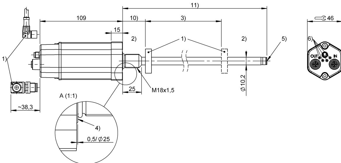
1) nicht im Lieferumfang, 2) nicht nutzbarer Bereich, 3) Nennlänge = Messlänge, 4) Anlagefläche, 5) Innengewinde M4x4/6 tief, 6) LED Funktionsanzeige, 10) Nullpunkt, 11) Einbaulänge
