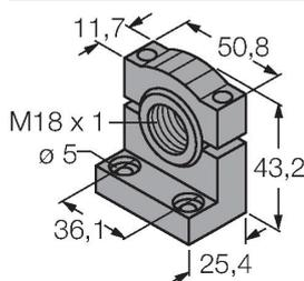
Montagehalterung, PBT-schwarz, für Sensoren mit 18-mm-Gewinde, ausrichtbar
