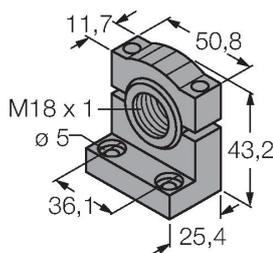
Montagehalterung, PBT-schwarz, für Sensoren mit 18-mm-Gewinde, ausrichtbar
