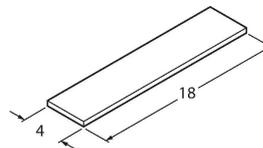
Kennzeichenschilder für TEL- und TXL-Leitungen; Schildlänge: 18 mm, Schildhöhe: 4 mm, Material: Polycarbonat (PC), Farbe: weiß, halogenfrei und flammwidrig
