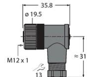
Konfektionierbare Kupplung, M12 x 1, gewinkelt, 4-polig, Schraubklemmanschluss, Leitungsdurchlass 4.0 bis 6.0 mm, Adernquerschnitt/ Klemmvermögen 0.14 bis 0.75 mm<sup>2</sup>, Kunststoffgehäuse, Kunststoffüberwurfmutter
