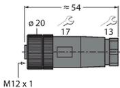
Konfektionierbare Kupplung, M12 x 1, gerade, 4-polig, Schraubklemmanschluss, Leitungsdurchlass 4.0 bis 6.0 mm, Adernquerschnitt/ Klemmvermögen 0.14 bis 0.75 mm<sup>2</sup>, Kunststoffgehäuse, Kunststoffüberwurfmutter
