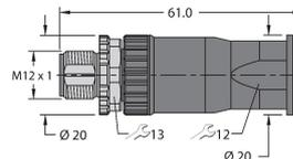
Konfektionierbarer Stecker, M12 x 1, gerade, 5-polig, Schraubklemmanschluss, Leitungsdurchlass 4.0 bis 8.0 mm, Adernquerschnitt/ Klemmvermögen 0.25 bis 1.5 mm<sup>2</sup>, Kunststoffgehäuse, Metallüberwurfschraube
