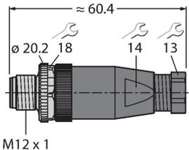
Konfektionierbarer Stecker, M12 x 1, gerade, 5-polig, Schraubklemmanschluss, Leitungsdurchlass 4.0 bis 6.0 mm, Adernquerschnitt/ Klemmvermögen 0.14 bis 0.75 mm<sup>2</sup>, Kunststoffgehäuse, Metallüberwurfschraube
