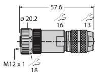
Konfektionierbare Kupplung, M12 x 1, gerade, 8-polig, Schraubklemmanschluss, Leitungsdurchlass 6.0 bis 8.0 mm, Adernquerschnitt/Klemmvermögen 0.14 bis 0.50 mm<sup>2</sup>, Metallgehäuse, Metallüberwurfmutter, schirmbar
