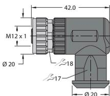
Konfektionierbare Kupplung, M12 x 1, gewinkelt, 5-polig, Schraubklemmanschluss, Leitungsdurchlass 4.0 bis 8.0 mm, Adernquerschnitt/Klemmvermögen 0.25 bis 1.5 mm<sup>2</sup>, Kunststoffgehäuse, Metallüberwurfmutter
