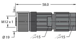
Konfektionierbare Kupplung, M12 x 1, gerade, 5-polig, Push-In-Anschluss, Leitungsdurchlass 4.0 bis 8.0 mm, Adernquerschnitt/Klemmvermögen 0.14 bis 0.75 mm<sup>2</sup>, Kunststoffgehäuse, Metallüberwurfmutter
