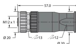
Konfektionierbare Kupplung, M12 x 1, gerade, 5-polig, Schraubklemmanschluss, Leitungsdurchlass 4.0 bis 8.0 mm, Adernquerschnitt/Klemmvermögen 0.25 bis 1.5 mm<sup>2</sup>, Kunststoffgehäuse, Metallüberwurfmutter
