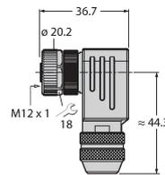
Konfektionierbare Kupplung, M12 x 1, gewinkelt, 5-polig, Schraubklemmanschluss, Leitungsdurchlass 6.0 bis 8.0 mm, Adernquerschnitt/Klemmvermögen 0.14 bis 0.75 mm<sup>2</sup>, Metallgehäuse, Metallüberwurfmutter, schirmbar
