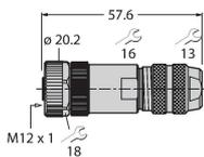
Konfektionierbare Kupplung, M12 x 1, gerade, 5-polig, Schraubklemmanschluss, Leitungsdurchlass 6.0 bis 8.0 mm, Adernquerschnitt/Klemmvermögen 0.14 bis 0.75 mm<sup>2</sup>, Metallgehäuse, Metallüberwurfmutter, schirmbar
