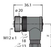
Konfektionierbare Kupplung, M12 x 1, gewinkelt, 4-polig, Schraubklemmanschluss, Leitungsdurchlass 4.0 bis 6.0 mm, Adernquerschnitt/ Klemmvermögen 0.25 bis 0.75 mm<sup>2</sup>, Kunststoffgehäuse, Metallüberwurfmutter
