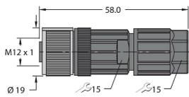
Konfektionierbare Kupplung, M12 x 1, gerade, 4-polig, Push-In-Anschluss, Leitungsdurchlass 4.0 bis 8.0 mm, Adernquerschnitt/Klemmvermögen 0.14 bis 0.75 mm<sup>2</sup>, Kunststoffgehäuse, Metallüberwurfmutter
