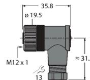
Konfektionierbare Kupplung, M12 x 1, gewinkelt, 4-polig, Schraubklemmanschluss, Leitungsdurchlass 4.0 bis 6.0 mm, Adernquerschnitt/ Klemmvermögen 0.14 bis 0.75 mm<sup>2</sup>, Kunststoffgehäuse, Kunststoffüberwurfmutter
