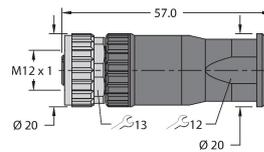
Konfektionierbare Kupplung, M12 x 1, gerade, 4-polig, Schraubklemmanschluss, Leitungsdurchlass 4.0 bis 8.0 mm, Adernquerschnitt/Klemmvermögen 0.25 bis 1.5 mm<sup>2</sup>, Kunststoffgehäuse, Metallüberwurfmutter
