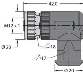
Konfektionierbare Kupplung, M12 x 1, gewinkelt, 4-polig, Schraubklemmanschluss, Leitungsdurchlass 4.0 bis 8.0 mm, Adernquerschnitt/Klemmvermögen 0.25 bis 1.5 mm<sup>2</sup>, Kunststoffgehäuse, Metallüberwurfmutter
