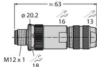
Konfektionierbarer Stecker, M12 x 1, gerade, 8-polig, Schraubklemmanschluss, Leitungsdurchlass 6.0 bis 8.0 mm, Adernquerschnitt/Klemmvermögen 0.14 bis 0.50 mm<sup>2</sup>, Metallgehäuse, Metallüberwurfmutter, schirmbar, u. A. auch für Ethernet
