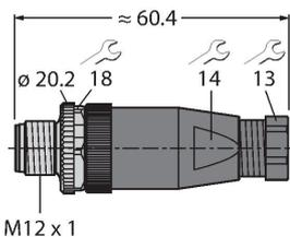
Konfektionierbarer Stecker, M12 x 1, gerade, 5-polig, Schraubklemmanschluss, Leitungsdurchlass 4.0 bis 6.0 mm, Adernquerschnitt/Klemmvermögen 0.14 bis 0.75 mm<sup>2</sup>, Kunststoffgehäuse, Metallüberwurfschraube
