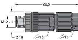
Konfektionierbarer Stecker, M12 x 1, gerade, 5-polig, Push-In-Anschluss, Leitungsdurchlass 4.0 bis 8.0 mm, Adernquerschnitt/Klemmvermögen 0.14 bis 0.75 mm<sup>2</sup>, Kunststoffgehäuse, Metallüberwurfschraube
