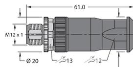
Konfektionierbarer Stecker, M12 x 1, gerade, 5-polig, Schraubklemmanschluss, Leitungsdurchlass 4.0 bis 8.0 mm, Adernquerschnitt/Klemmvermögen 0.25 bis 1.5 mm<sup>2</sup>, Kunststoffgehäuse, Metallüberwurfschraube
