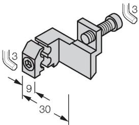
Klemmstück zur Montage von Magnetfeldsensoren auf # Profizylindern mit außenliegender Schwalbenschwanzführung; Zylinderdurchmesser: 32...200 mm; Werkstoff: Aluminium
