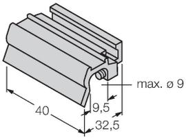
Zubehör zur Montage des Sensors BIM-INT und BIM-UNT auf Zugankerzylinder; Zylinderdurchmesser: 50... 63 mm; Werkstoff: Aluminium; weitere Zusatzhalterungen für unterschiedliche Zylinderdurchmesser auf Anfrage
