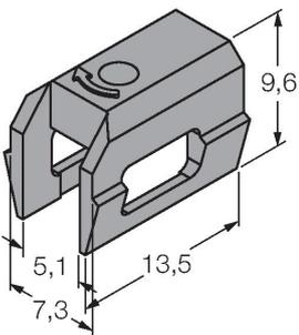
Klemmstück zur Montage von Magnetfeldsensoren auf Schwalbenschwanznutzylinder; Nutbreite: 7,35 mm; Werkstoff: PPS
