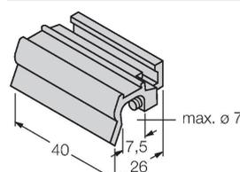
Zubehör zur Montage des Sensors BIM-INT und BIM-UNT auf Zugankerzylinder; Zylinderdurchmesser: 32... 40 mm; Werkstoff: Aluminium; weitere Zusatzhalterungen für unterschiedliche Zylinderdurchmesser auf Anfrage
