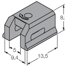
Klemmstück zur Montage von Magnetfeldsensoren auf Schwalbenschwanznutzylinder; Nutbreite: 9,4 mm; Werkstoff: PPS
