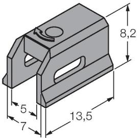
Klemmstück zur Montage von Magnetfeldsensoren auf Schwalbenschwanznutzylinder; Nutbreite: 7 mm; Werkstoff: PPS
