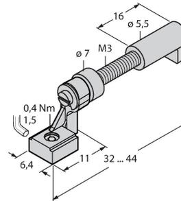
Zubehör zur Feinjustage des Schaltpunktes auf T-Nutzylindern; in die Zubehöraufnahmen des Sensors BIM-UNT einschnappbar; zur Mehrfachverwendung geeignet; Werkstoff: Metall / Kunststoff
