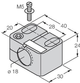
Befestigungsschelle für Gewinderohrsensoren, mit Festanschlag; Werkstoff: PA6
