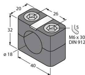
Befestigungsschelle für Gewinderohrsensoren; Werkstoff: PA66-GF
