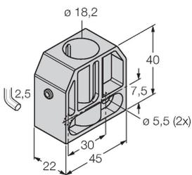
Befestigungsschelle für Gewinderohrsensoren; Werkstoff: PA66-GF
