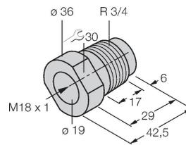
Montageadapter; Werkstoff: Polypropylen; Sensorwechsel bei gefüllten Behälter möglich (Adapter verbleibt beim Sensortausch im Behälter)
