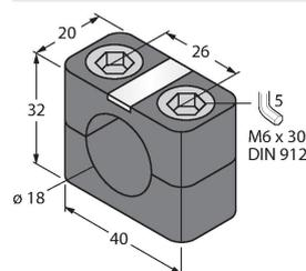
Befestigungsschelle für Gewinderohrsensoren; Werkstoff: PA66-GF
