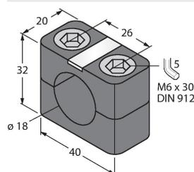
Befestigungsschelle für Gewinderohrsensoren; Werkstoff: PA66-GF
