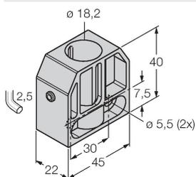
Befestigungsschelle für Gewinderohrsensoren; Werkstoff: PA66-GF
