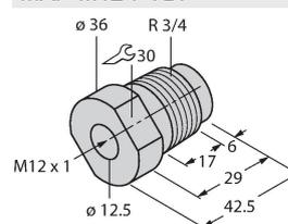
Montageadapter; Werkstoff: Polyvinylidenfluorid; Sensorwechsel bei gefüllten Behälter möglich (Adapter verbleibt beim Sensortausch im Behälter)
