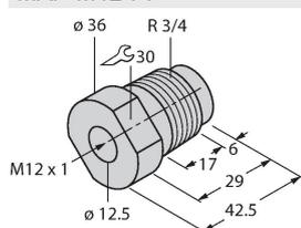
Montageadapter; Werkstoff: Polypropylen; Sensorwechsel bei gefüllten Behälter möglich (Adapter verbleibt beim Sensortausch im Behälter)
