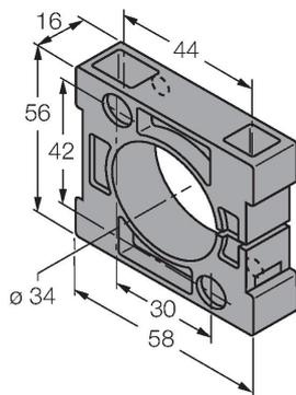
Befestigungsschelle: Werkstoff Montageblock (PBT-GF20-V0); im Lieferumfang enthalten (2 Schrauben M5 zur Bodenmontage)
