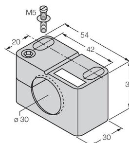
Befestigungsschelle für Gewinderohrsensoren, mit Festanschlag; Werkstoff: PA6
