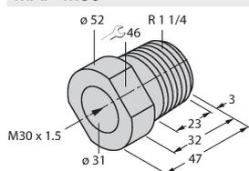
Montageadapter; Werkstoff: Polypropylen; Sensorwechsel bei gefüllten Behälter möglich (Adapter verbleibt beim Sensortausch im Behälter)
