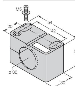
Befestigungsschelle für Gewinderohrsensoren, mit Festanschlag; Werkstoff: PA6
