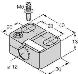
Befestigungsschelle für Gewinderohrsensoren, mit Festanschlag; Werkstoff: PA6
