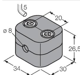
Befestigungsschelle für Glatt- und Gewinderohrsensoren; Werkstoff: Polypropylen
