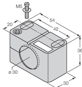
Befestigungsschelle für Gewinderohrsensoren, mit Festanschlag; Werkstoff: PA6
