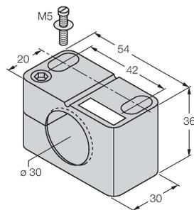
Befestigungsschelle für Gewinderohrsensoren, mit Festanschlag; Werkstoff: PA6
