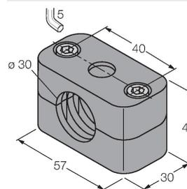
Befestigungsschelle für Glatt- und Gewinderohrsensoren; Werkstoff: Polypropylen
