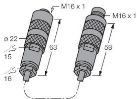
Adapterkabel zum getrennten Aufbau von Ringsonde und Schaltverstärker; Koax-Leitung: RG58 C/U 50 Ohm
