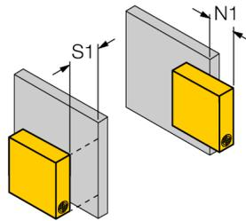
**Es ist darauf zu achten, dass dieser Sensor nicht-bündig eingebaut werden muss.**
