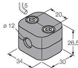
Befestigungsschelle für Glatt- und Gewinderohrsensoren; Werkstoff: Polypropylen
