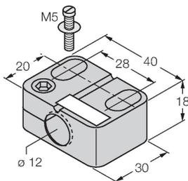
Befestigungsschelle für Gewinderohrsensoren, mit Festanschlag; Werkstoff: PA6
