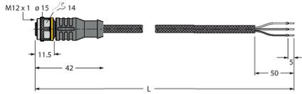
Anschlussleitung, M12-Kupplung, gerade, 3-polig, Leitungslänge: 2m, Schutzmantelmaterial: Aramidfasern, gelb; Temperaturspitze: 200°C; andere Leitungslängen und Ausführungen lieferbar, siehe [www.turck.com](http://www.turck.com)
