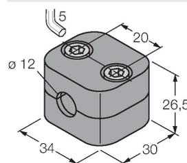
Befestigungsschelle für Glatt- und Gewinderohrsensoren; Werkstoff: Polypropylen
