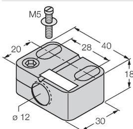
Befestigungsschelle für Gewinderohrsensoren, mit Festanschlag; Werkstoff: PA6
