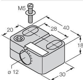
Befestigungsschelle für Gewinderohrsensoren, mit Festanschlag; Werkstoff: PA6
