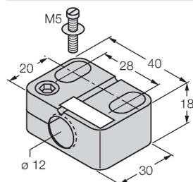
Befestigungsschelle für Gewinderohrsensoren, mit Festanschlag; Werkstoff: PA6
