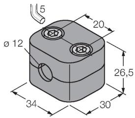
Befestigungsschelle für Glatt- und Gewinderohrsensoren; Werkstoff: Polypropylen
