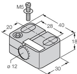
Befestigungsschelle für Gewinderohrsensoren, mit Festanschlag; Werkstoff: PA6
