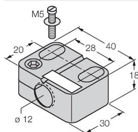
Befestigungsschelle für Gewinderohrsensoren, mit Festanschlag; Werkstoff: PA6
