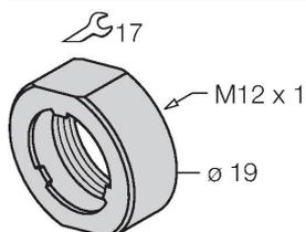
Stoßschutzmutter für M12x1 Gewinderohrgeräte; Werkstoff: Edelstahl A2 1.4305 (AISI 303)
