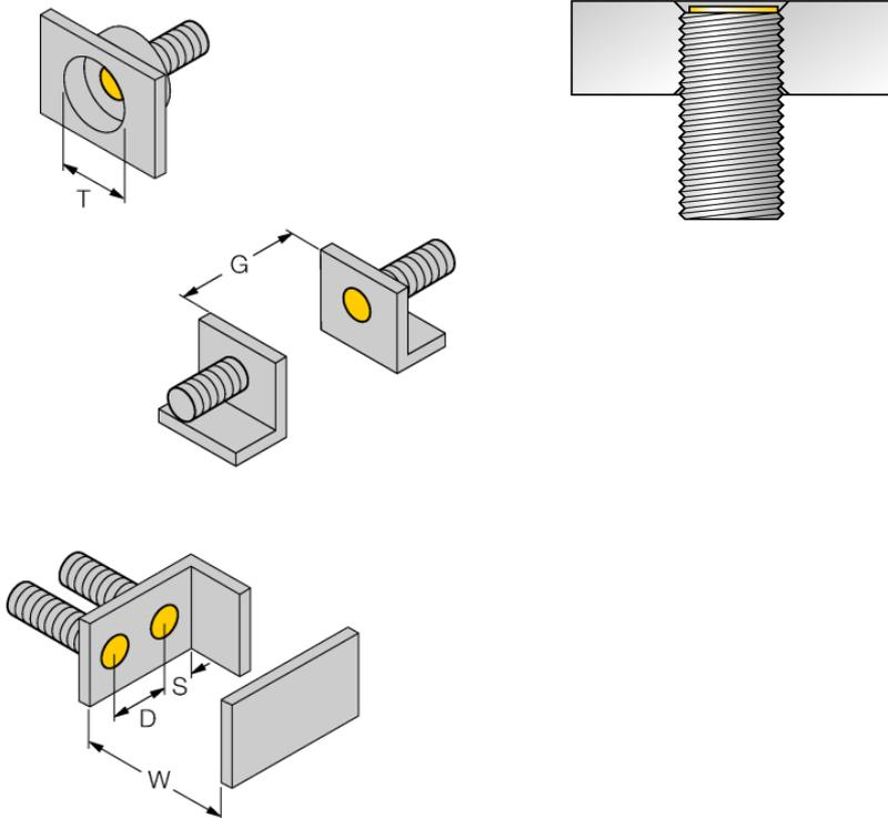
Bei allen bündigen uproX+ Gewinderohrschaltern ist ein überbündiger Einbau erlaubt. Bei einem zurückgesetzten Einbau von einer halben Gewindeumkehrung ist ein sicherer Betrieb gewährleistet.
