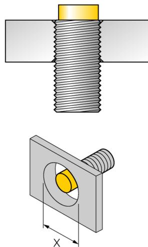
Bei allen nichtbündigen *uprox®+* Gewinderohrschaltern ist ein Einbau bis zur Rohrkante erlaubt. Ein sicherer Betrieb ist hierbei mit einer maximalen Reduzierung des Schaltabstandes von 20% gewährleistet.
