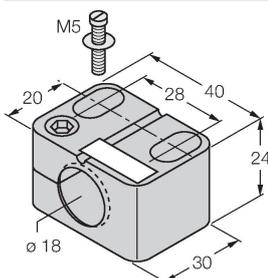
Befestigungsschelle für Gewinderohrsensoren, mit Festanschlag; Werkstoff: PA6
