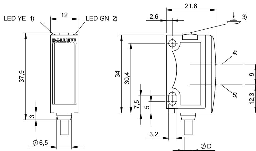
1) Ausgangsfunktion, 2) Betriebsspannung, 3) Sn, Hell/Dunkel, 4) Optische Achse Empfänger, 5) Optische Achse Sender
