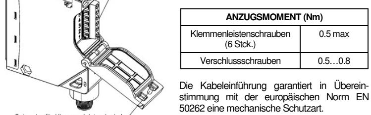
Die Kableinführung garantiert in Übereinstimmung mit der europäischen Norm EN 50262 eine mechanische Schutzart.
