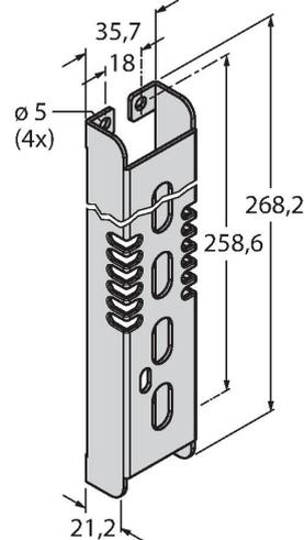
Montagehalterung, für PVD225, kaltgewalzter Stahl, keine Aussparung für DIP-Schalter-Bank
