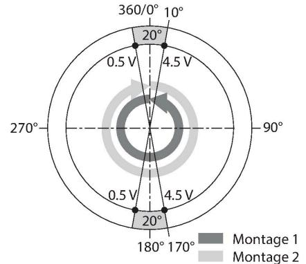
Es gibt zwei unterschiedliche Montagemöglichkeiten. Einerseits kann der Positionsgeber oberhalb des Sensorgehäuses positioniert werden. Er kann aber auch so montiert werden, dass das Sensorgehäuse den Positionsgeber komplett umschließt.
